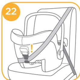
3. Tire del cinturón para ajustar el autoasiento firme y correctamente. 23
